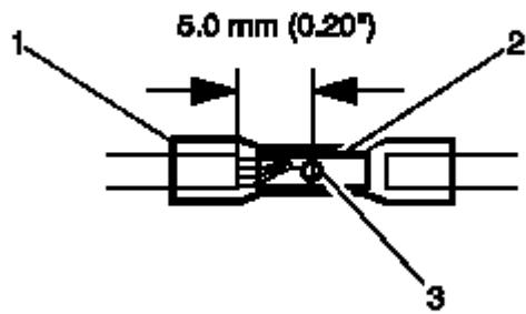
8. 将DuraSeal接头套管放入嵌套中。确保压接点落在内管端部和挡块的中间。该套管在内管(2)中央有一个挡块(3)，防止导线(1)滑入。轻微夹紧压接钳手柄，将DuraSeal接头套管牢固地固定在合适的嵌套中。
